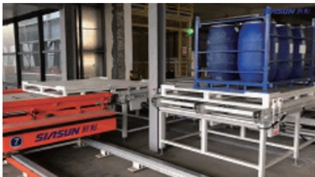
采用RGV及智能动态调度算法实现产品的智能输送，可有效满足企业1000吨/天的生产能力
